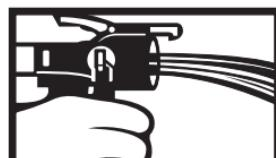
5. Selezionare l'ugello desiderato e inserirlo nell'erogatore INSTA-FLO™. Assicurarsi che l'ugello sia saldamente agganciato all'erogatore.
