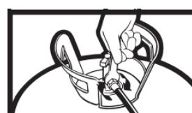
La llave está diseñada de forma intencionada para deformarse o doblarse si se ejerce una presión excesiva.
