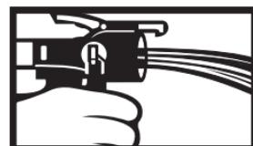
4. Drücken Sie den Abzug des INSTA-FLO™ Dispensers über einem Abfallbehälter, um das System zu leeren. **Der Schaum muss einen gleichmäßigen Fluss haben, um seine guten Eigenschaften zu erzielen.** Wird der Fluss gleichmäßig, lassen Sie den Abzug los. Der Dispenser ist dann mit einem feuchten Lappen zu reinigen und im Anschluss ist die Rohvaseline aufzutragen.
