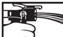
5. Seleccione e introduzca firmemente una boquilla Anti-Crossover en el aplicador INSTA-FLO™. Asegúrese de que la boquilla quede bien sujetada y colocada en el aplicador.
