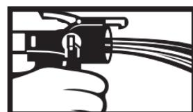
5. Selecione e aplique firmemente um bico anti-cruzamento no aplicador INSTA-FLO™. Certifique-se que o bico se encontra bem fixado no conjunto de aplicação.
